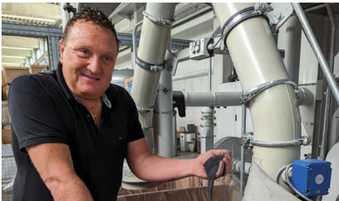
Ausschuss wird zerkleinert und erneut verwendet.
